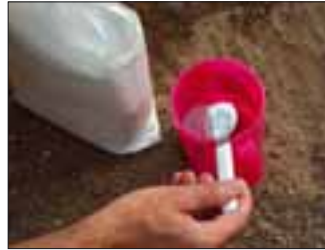
4. Procedemos a realizar la mezcla de agua y polvo de escayola.
